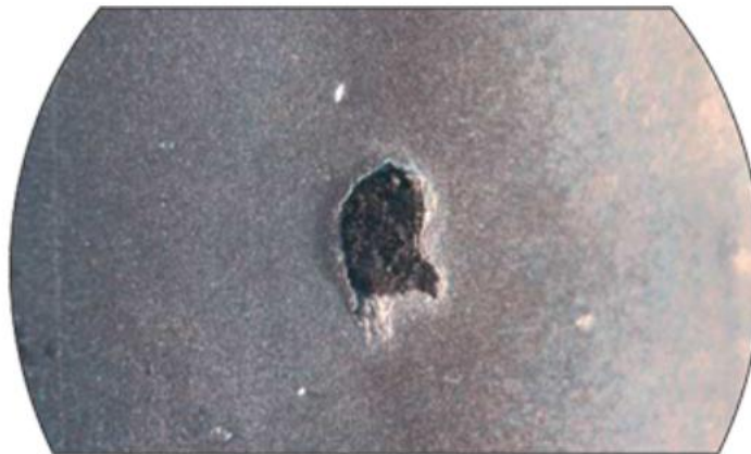
写真5。「XADO修復」グリース高負荷運転の15分後に、軸受の同じ部分。表面は滑らかでガラス質です。工場出荷時の研磨の痕跡が完全に消えてしまいました。まだクレーターの跡を見ることができますが、明確にバックアップピンホールを再構築、セラミック - 金属層の発生を確認することができます。
